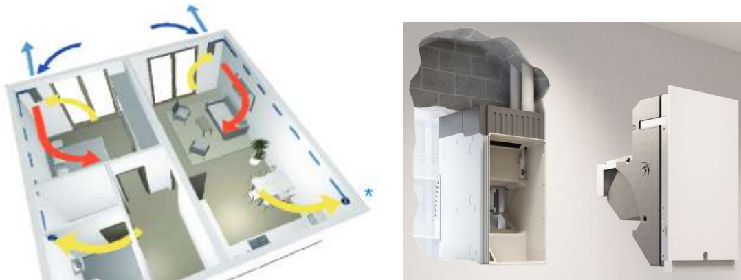
Bild 8: Einzelraumlüfter mit Zweitraumanschluss (Abluft Bad/WC und Küche) (Quelle: Domo Air)
